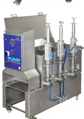
Три поршневых насоса для сиропа с разделенным резервуаром
