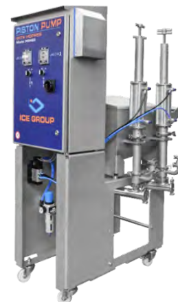
Два поршневых насоса для сиропа с разделенным резервуаром
