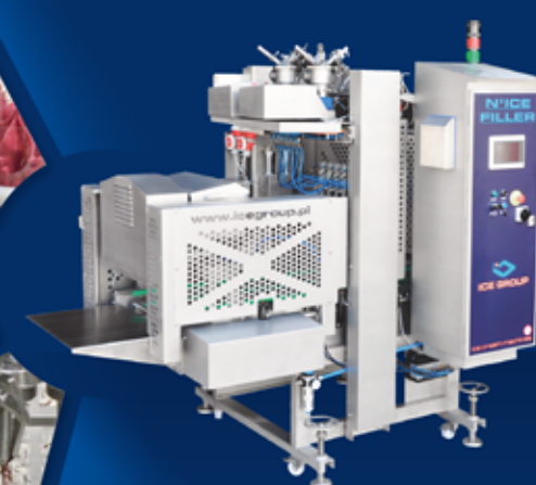
N'ICE FILLER llenadora de envases de vidrio, cerámica y otros envases especiales, tipo copas, escudillas, vasitos de barquillo o chocolate
